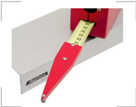
/ Aufmaßseinheit: Sie wird auf die Stufenvorderkante gelegt und errechnet aus Drehwinkel und Auszugslänge hochpräzise die erfassten Stufenpunkte.
